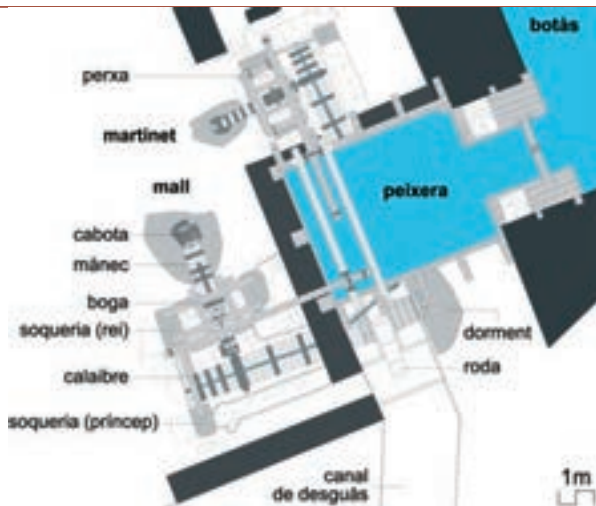
Planta del mall i del martinet de la farga Rossell (ARH).
