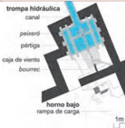
Planta del bajo horno y de la trompa de la ferrería Rossell (ARH).
